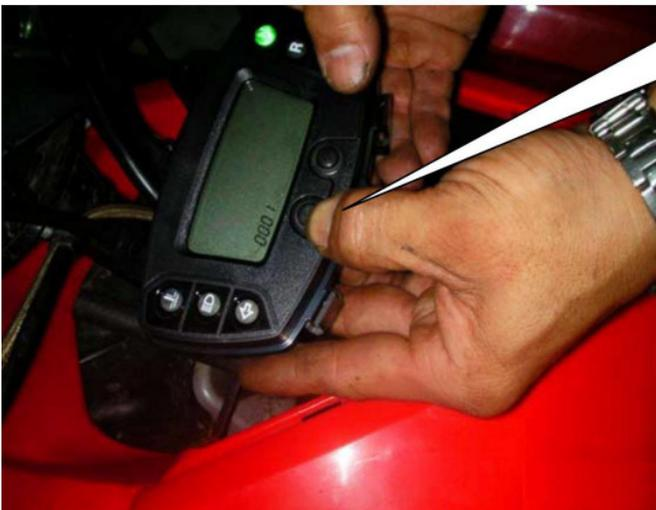
Der linke Schalter ist zum wechseln der Position nach links für die Zahl die geändert werden soll
